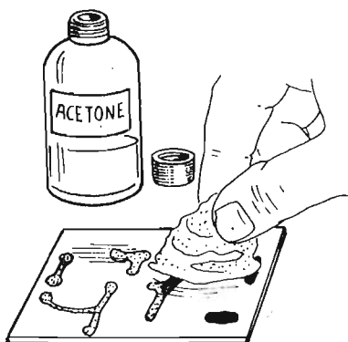
Fig. 9 - Dopo aver bene lavato la piastrina e dopo averla fatta asciugare, occorre eliminare la vernice o lo smalto che ancora ricoprono le piste di rame. Ciò si ottiene strofinando la superficie della piastra con un batuffolo di cotone imbevuto di acetone.
